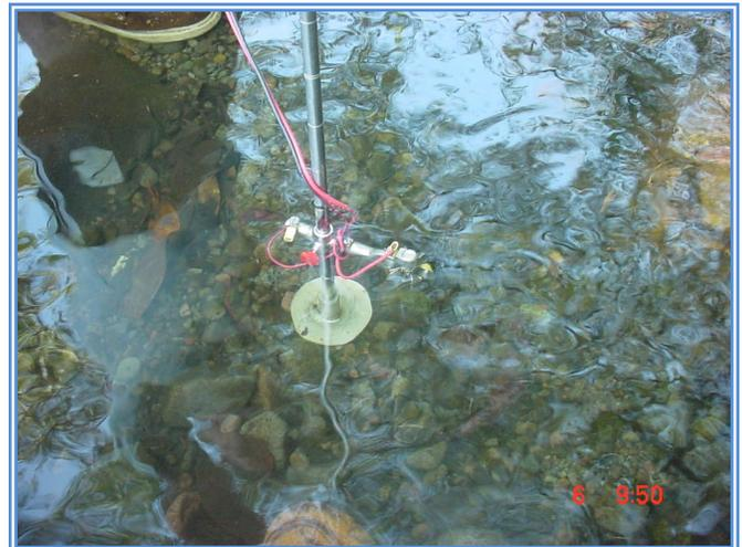
Fig. 22 Medición de caudal, aforo por vadeo con Molinete en la estación hidrológica Macho de Monte.
