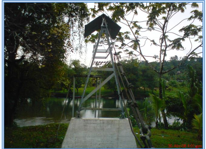
Fig. 12 Cablevía y carro de aforo de la estación Canquintú, río Cricamola.
