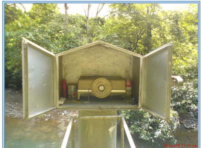
Fig. 33 Limnógrafo Stevens A-35 (registrador gráfico continuo de nivel de agua), estación hidrológica Rincón.
