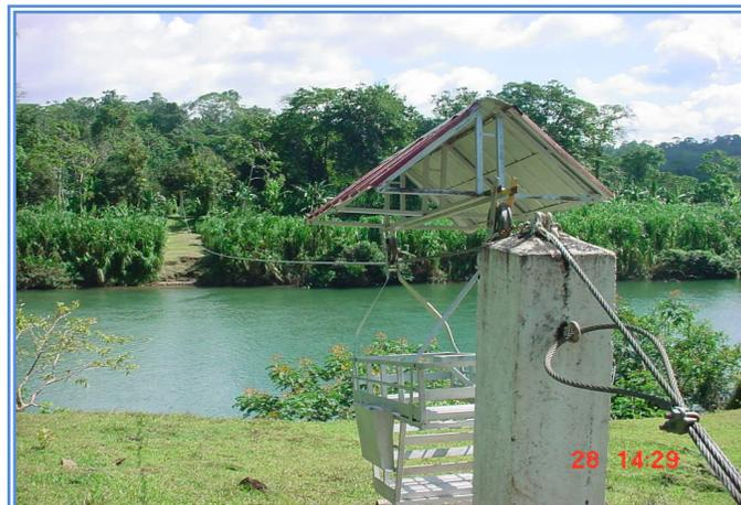
Fig. 16 Carro de aforo sobre el río Calovébora, en Los Cedros.
