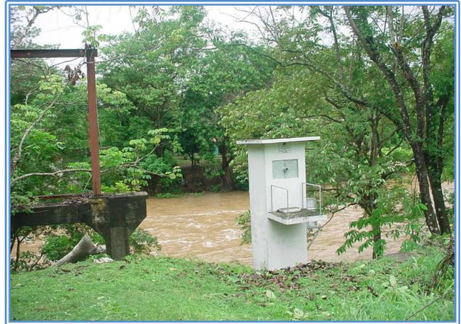
Fig. 60 Pozo amortiguador, estación hidrológica río Mamóni.
